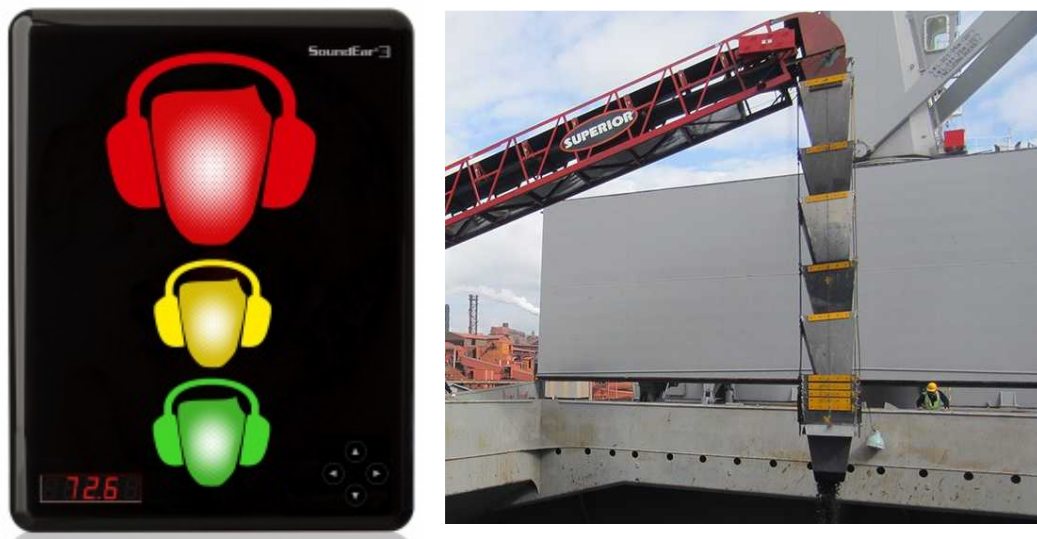
Figur 3-8. Exempel på ljud- och ljusövervakning, vänster (3-7a), och transportör med så kallad strumpa för att minska ljudet från fallande berg (3-7b).
