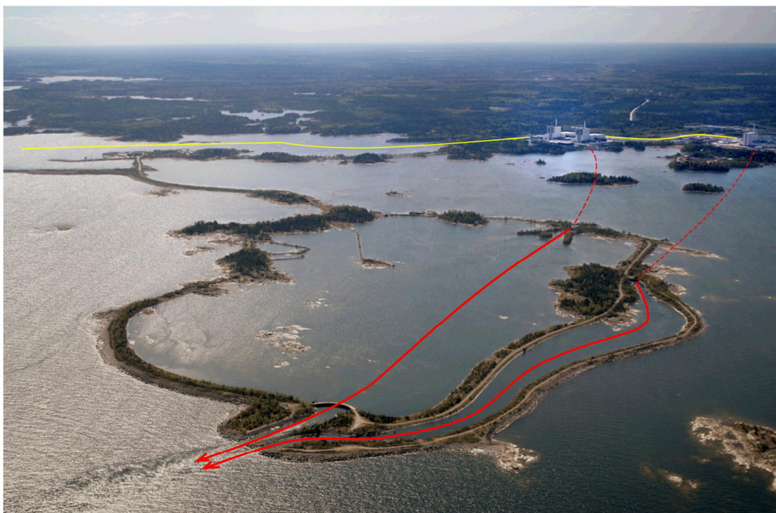
Figur 2-4. Strömningsförhållanden utsläpp av kylvatten från FKA.
