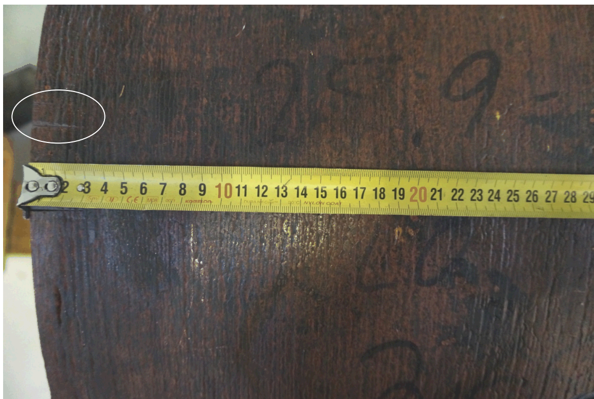
Figur 8-2. Hanteringsskada inringad ovanför måttbandet på koppargöt för rörtillverkning.
