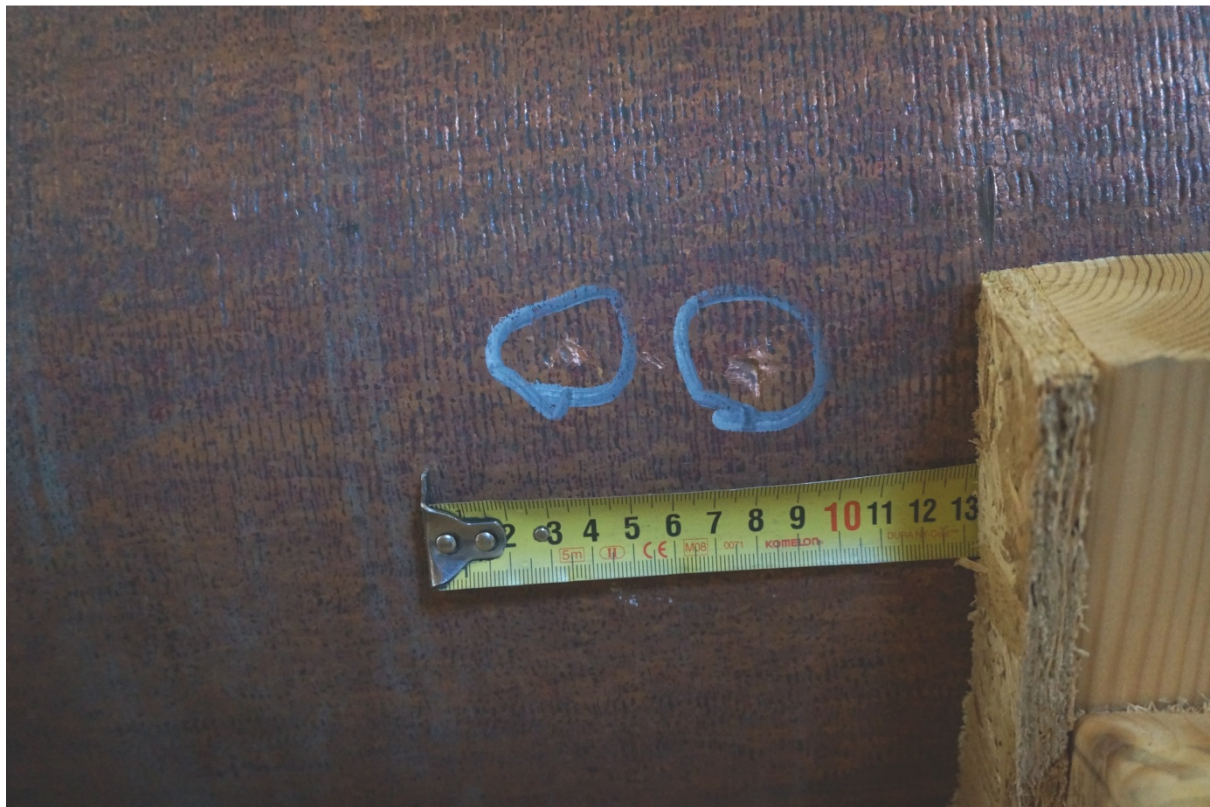
Figur 9-1. Hanteringsskador som ringats in på mantelytan på ett lockgöt.
