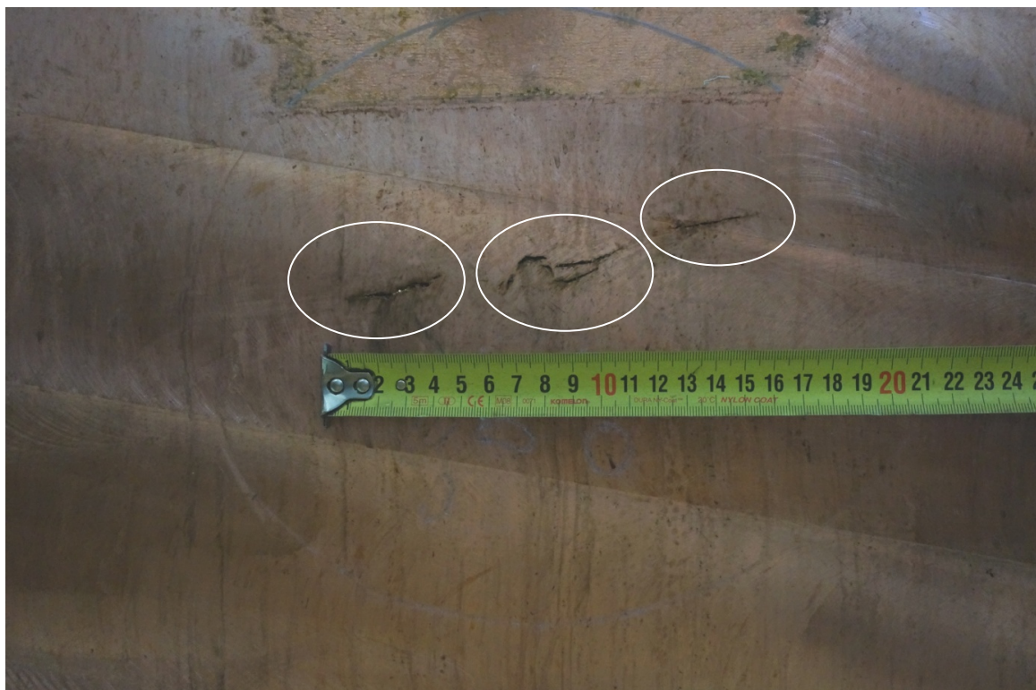
Figur 8-3. Spider cracks som ringats in ovanför måttbandet på änden av koppargöt för tillverkning av rör.
