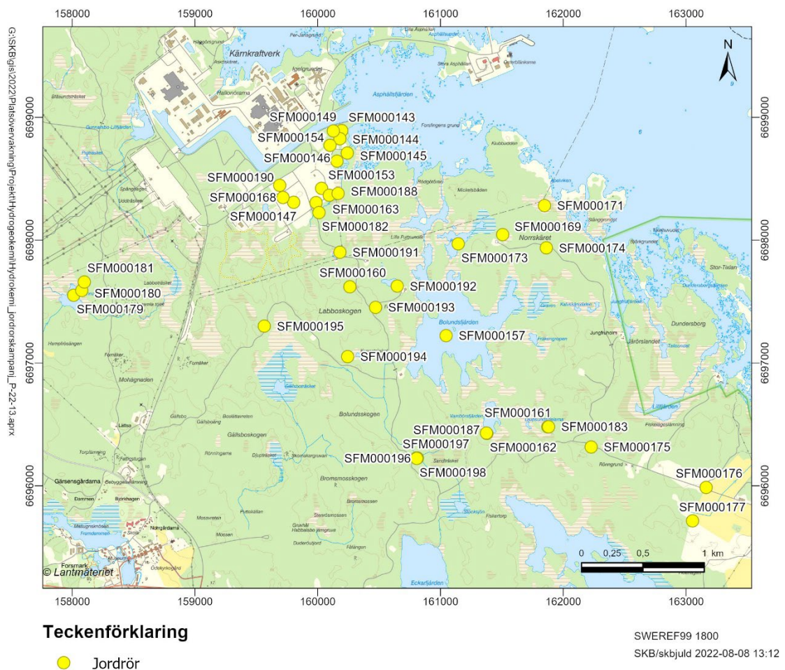
Figur 2-1 Ingående jordrör i hydrokemiska undersökningen 2021 i rör installerade 2015–2020 inom Forsmarks undersökningsområde.
