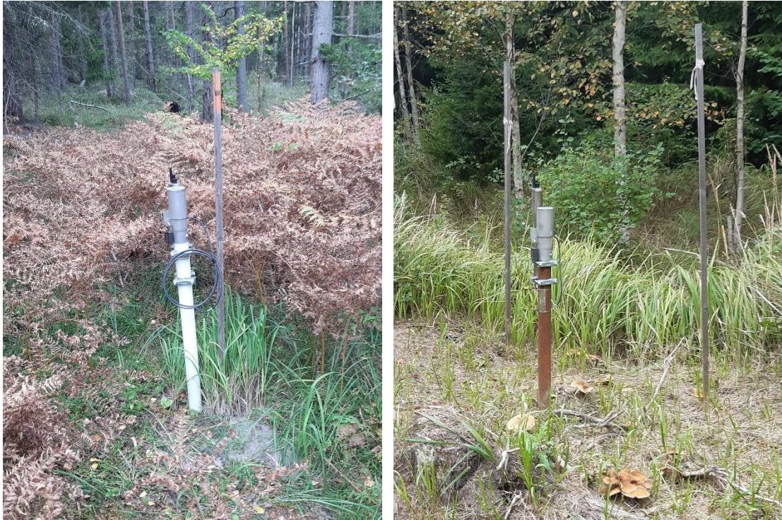
Figur 2-2 Grundvattenrör SFM000194 med casing av PEH-plast (t. v.) och grundvattenrör SFM000195 med casing av järn (t. h.).
