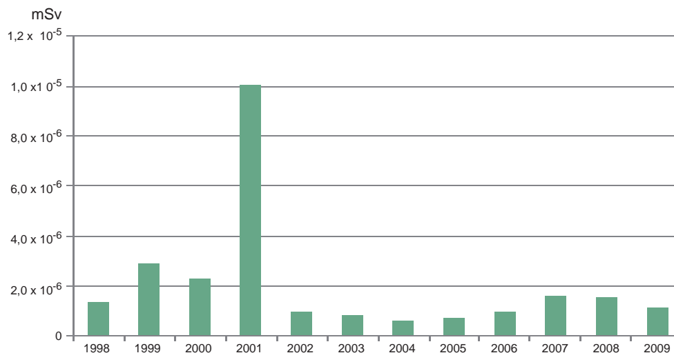
Figur 8-17. Dos till kritisk grupp från årligt utsläpp till luft från Clab under perioden 1998–2009.
