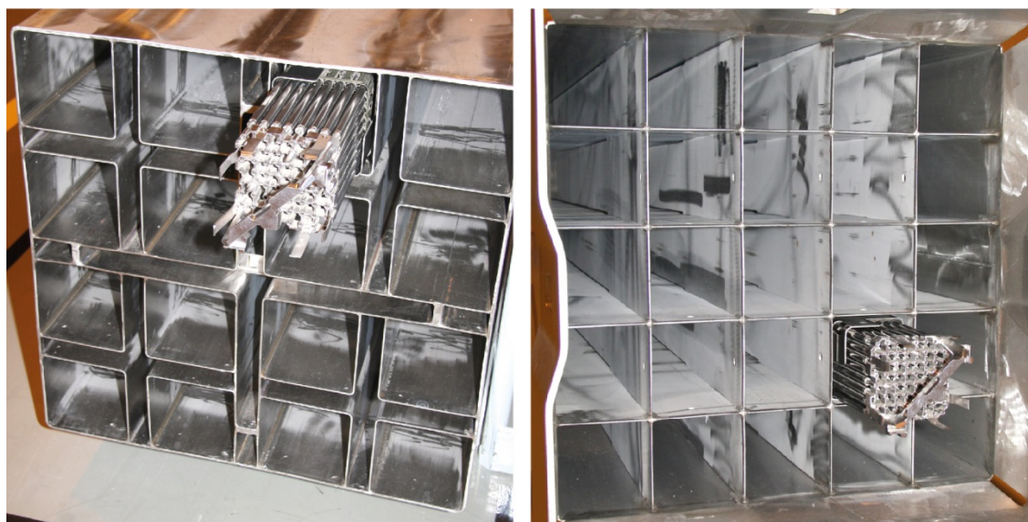
Figur 4-1. Till vänster visas en normalkasset som rymmer 16 bränsleelement av BWR-typ och till höger en kompaktkasset som rymmer 25 bränsleelement av BWR-typ.
