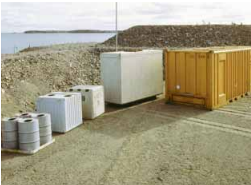
Olika typer av avfallsbehållare för låg- och medelaktivt avfall.
