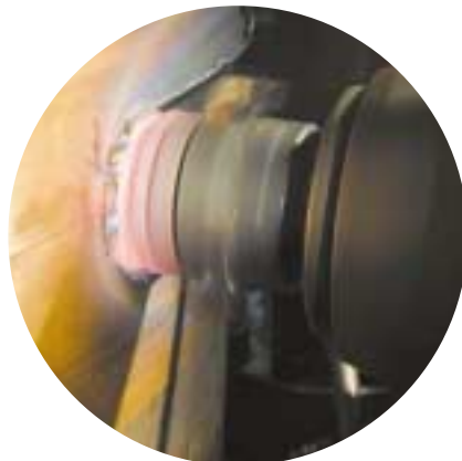
Temperaturen vid friction stir welding uppgår till ungefär 850 °C.
