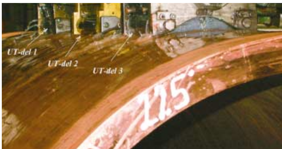
Ultraljudsmätningar i olika riktningar.
