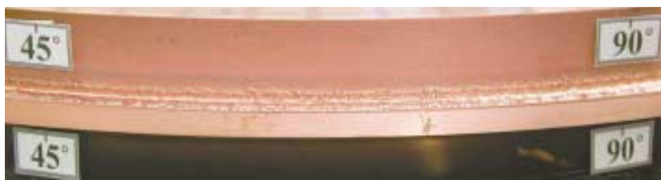
Svets gjord med elektronstrålesvetsning.
