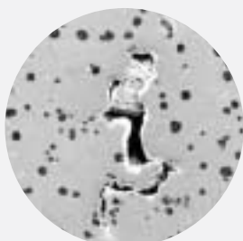
Ibland bildas porositeter (håligheter) vid gjutningen.
