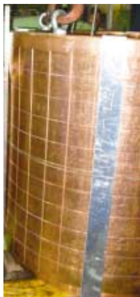
Så här såg provkapseln ut efter att ha utsatts för ett tryck av 135 MPa. Kopparhöljet hade deformerats upp till 20 millimeter på sina ställen, men kapseln var fortfarande hel.
