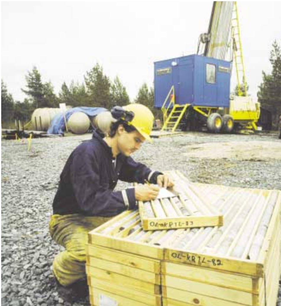
Undersökningar av borrhäror i Olkiluoto, platsen för det finska slutförvaret.
