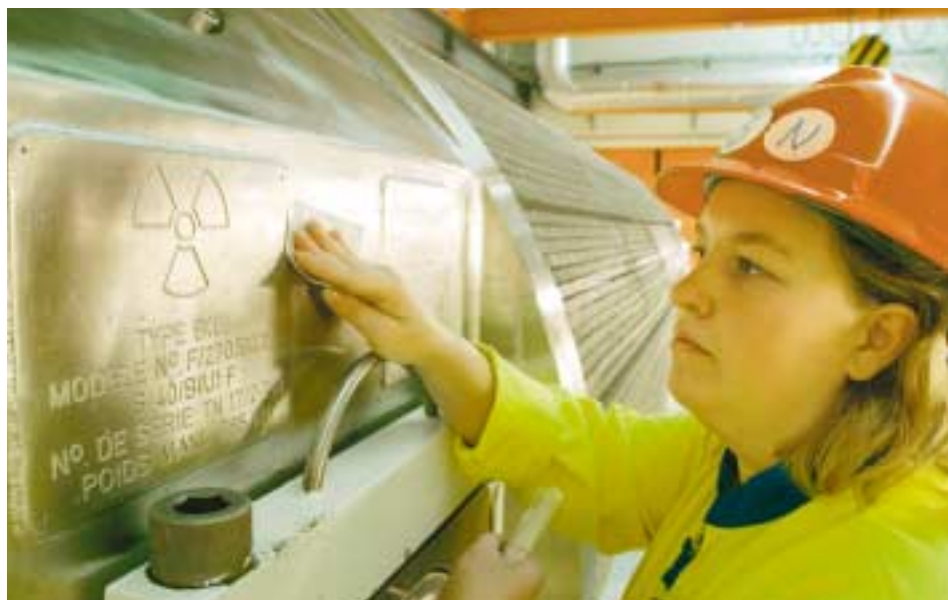
Transporten av det använda kärnbränslet från kraftverken till Clab sker i specialbyggda behållare, som dämpar strålningen.
