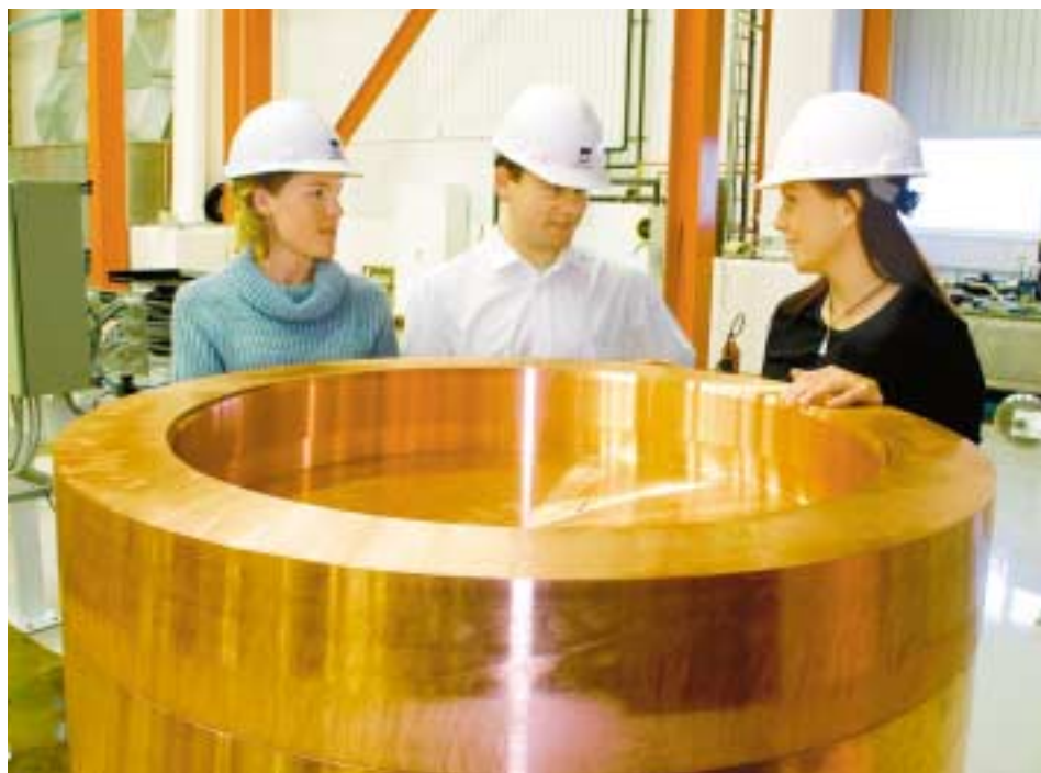
Kapselns hölje består av fem centimeter tjock koppar.
